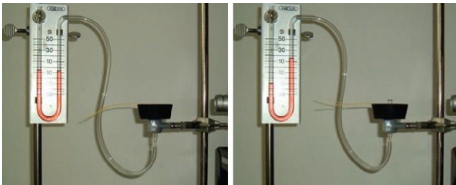
Fig. 9. Manómetro en forma U para medir presión del aire.
